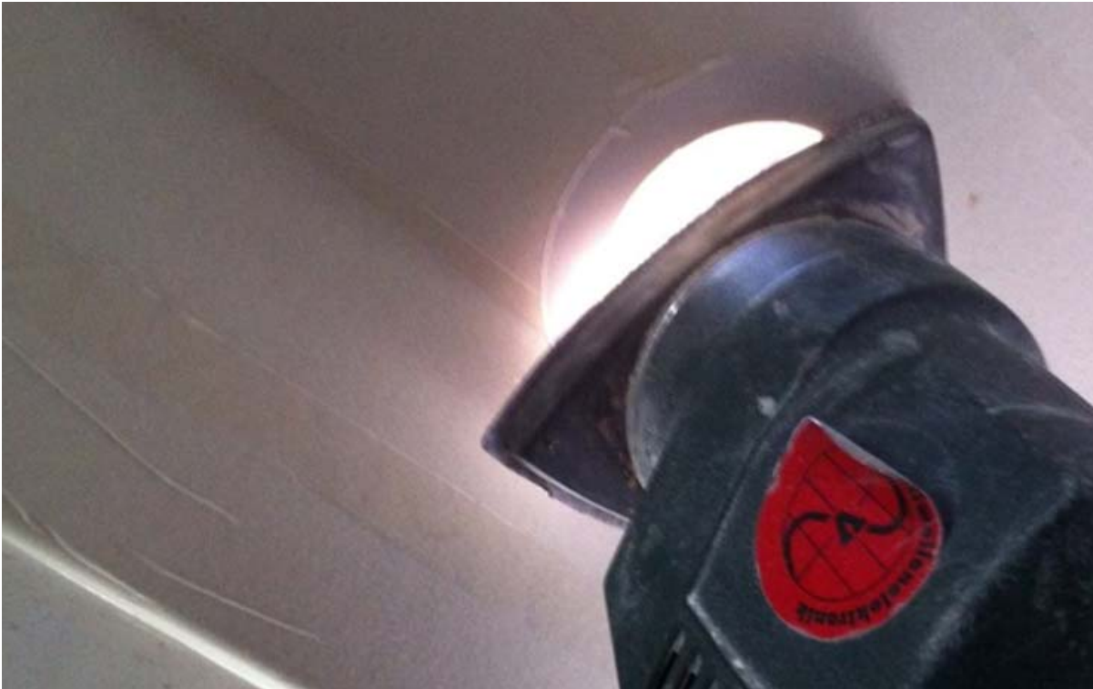
Gelcoat slibes let så man er sikker på at alt voks er væk. Derefter rengøres med acetone
